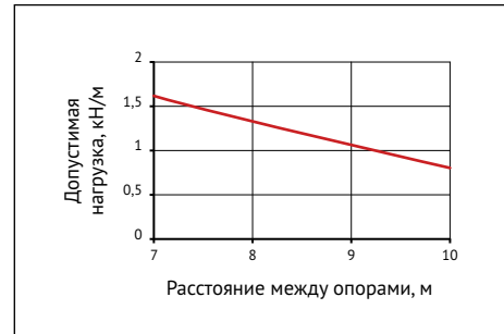
Диаграмма нагрузок на кабельный лоток
