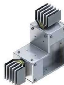
Магистральные шинопроводы KLM-S со степенью защиты IP55, IP65, IP66 с алюминиевыми и медными шинами на токи от 800 А до 6300 А в алюминиевом корпусе.
