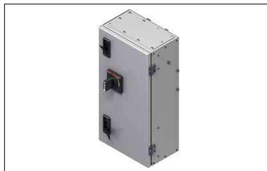
**Образец заказа:** коробка Plug-in 630 А с автоматом защиты в литом корпусе, наличие ручки управления для магистрального шинопровода 1600 А, IP55, с 4-мя медными проводниками, стальной корпус
