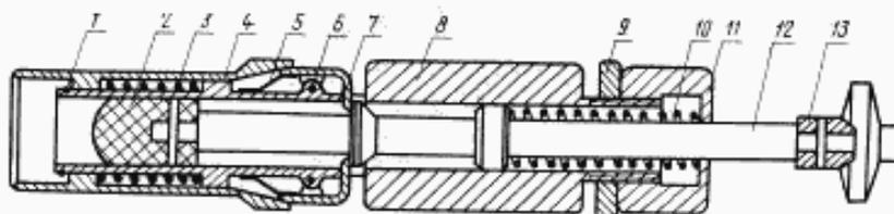
1 — кольцо стопорное; 2 — наконечник; 3 — пружина; 4 — головка; 5 — пружина;
